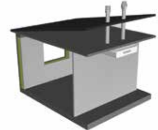
Entrée d'air et rejet en toiture
