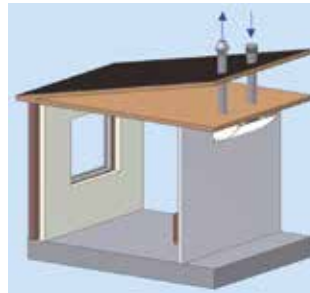
Entrée d'air et rejet en toiture
