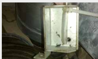
Les extrémités des capillaires en fond de colonne ne sont pas encrassées et le fonctionnement est toujours aussi performant.
