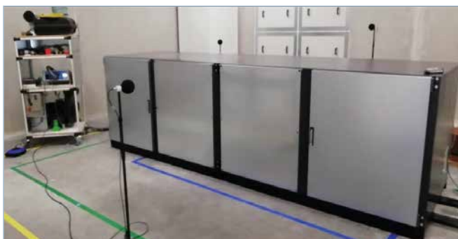
Model Box permettant de tester la carrosserie de la centrale en laboratoire
