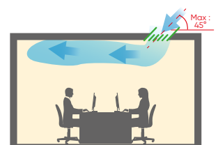
Cas d'un diffuseur plafonnier : l'angle de diffusion doit être inférieur à 45° pour assurer l'effet Coanda
