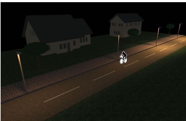
Exemple d'application : Éclairage cheminement résidentiel piétonnier, ou piste cyclable. Hauteur de pose : 4,5m. Interdistance : 13,5m.
