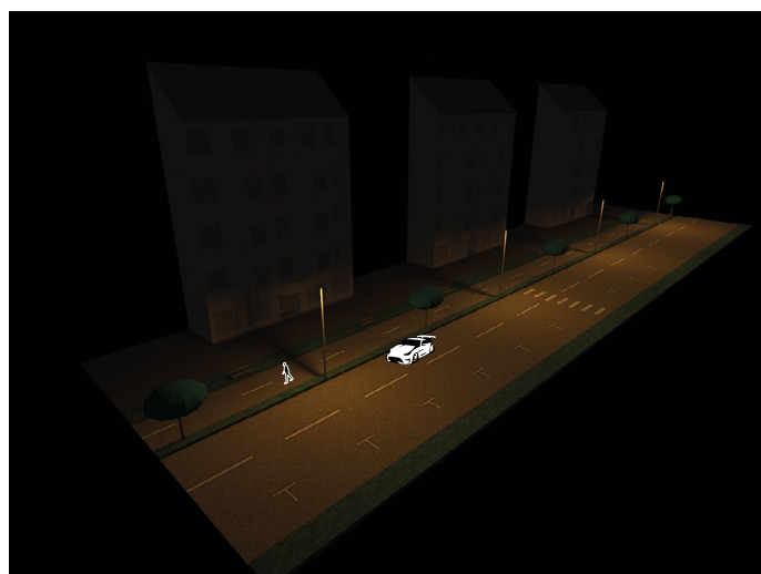
Exemple d'application : Éclairage d'une voie résidentielle et de la circulation piétonne. Nika Zhaga 100W [302572]. Hauteur de pose : 8m. Interdistances : 25m.
