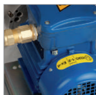
Moteur anti-explosif selon la Directive ATEX
