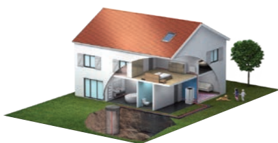
Captage sur sonde géothermique
